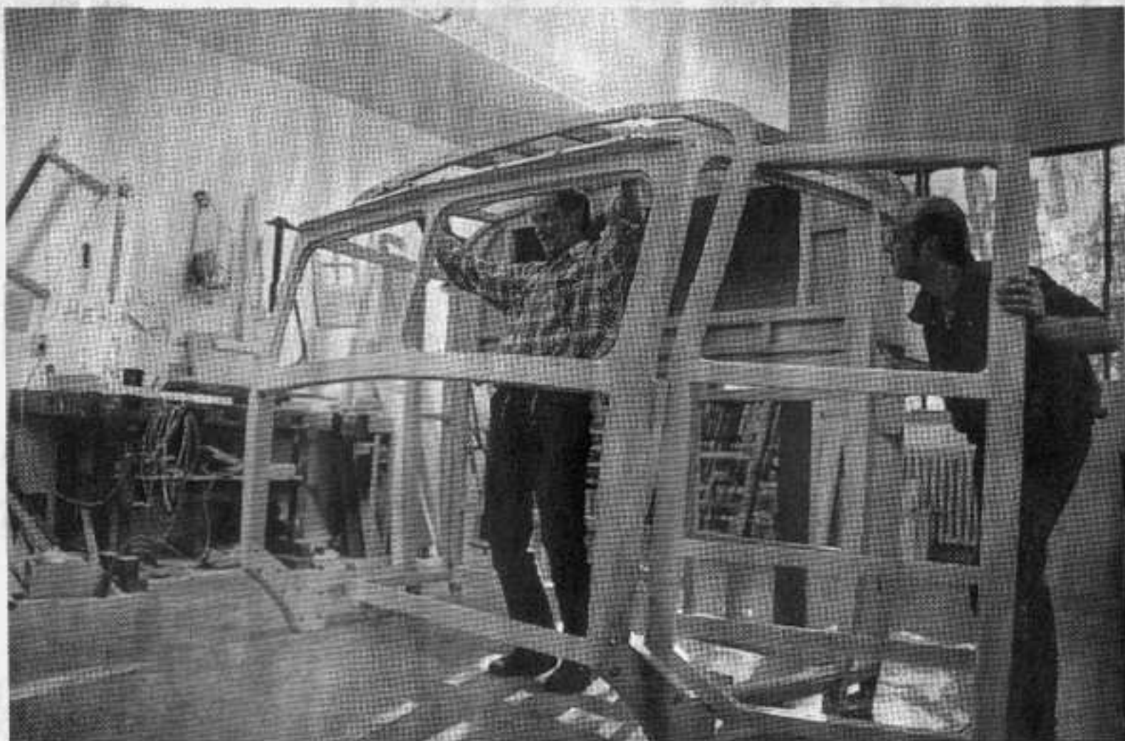
Ohne Fingerspitzengefühl geht nichts: Spezialisten Theo Malchus (links) und Andreas Hückmann am rekonstruierten Fahrerhaus für den Büssing 8000S. Foto: Rudolf Flentje
