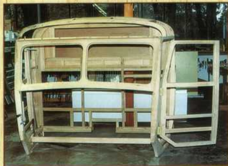
Fast nur aus Neuteilen: Holzgerippe für ein Achttausender-Fahrerhaus
