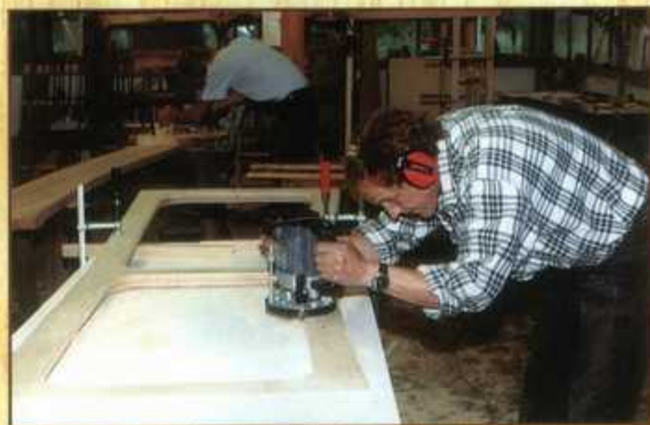
Theo Malchus beim Fräsen der Fenster-Rundungen
