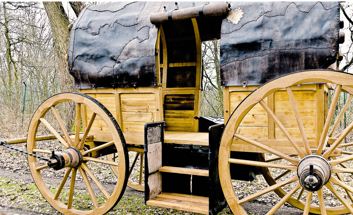
Aus Eichen-, Eschen-, Fichtenholz, Metall und Leder haben Braunschweiger Handwerker den Reisewagen nachgebaut.
