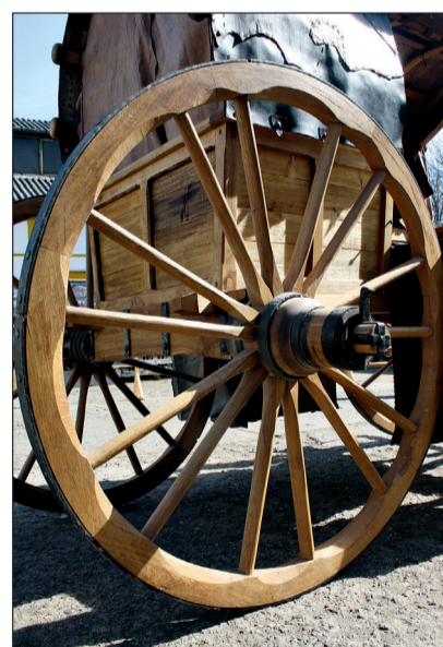
Extrem große Räder mit aufgenagelten Radreifen-Segmenten
