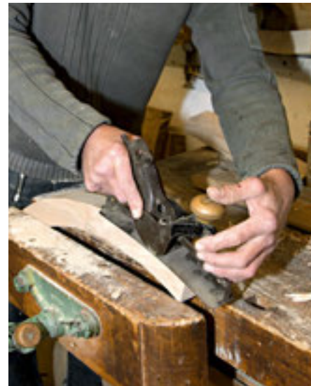
Dieser «historische», verstellbare Hobel kann die Rundungen der Felgenteile für Speichenräder nacharbeiten.
