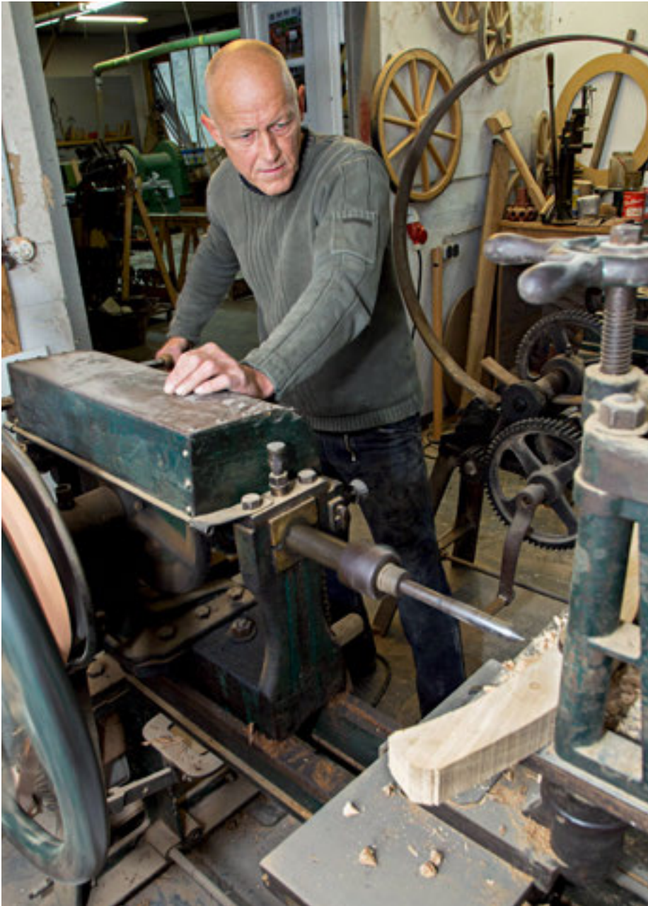
Die alte «Universal-Wagner-Maschine» macht einen ohrenbetäubenden Lärm, tut aber seit mehr als hundert Jahren ihren Dienst. Hier nutzt Theo Malchus die Transmissionsanlage, um das Loch für eine Speiche in ein Felgenteil zu bohren.
